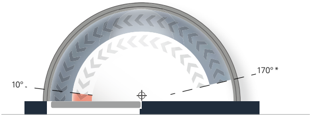
关门力度图示 ECO Newton TS-14, 铰链背侧
