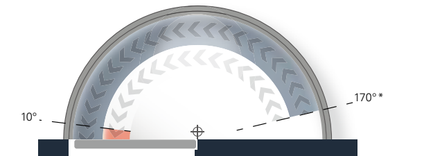
关门力度图示 ECO Newton TS-14 EN, 铰链背侧
